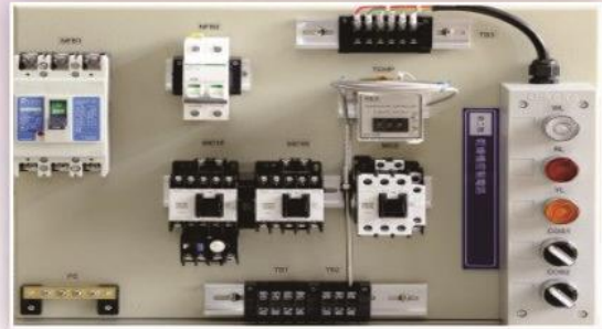
第4題 二台輸送帶電動機順序運轉控制
